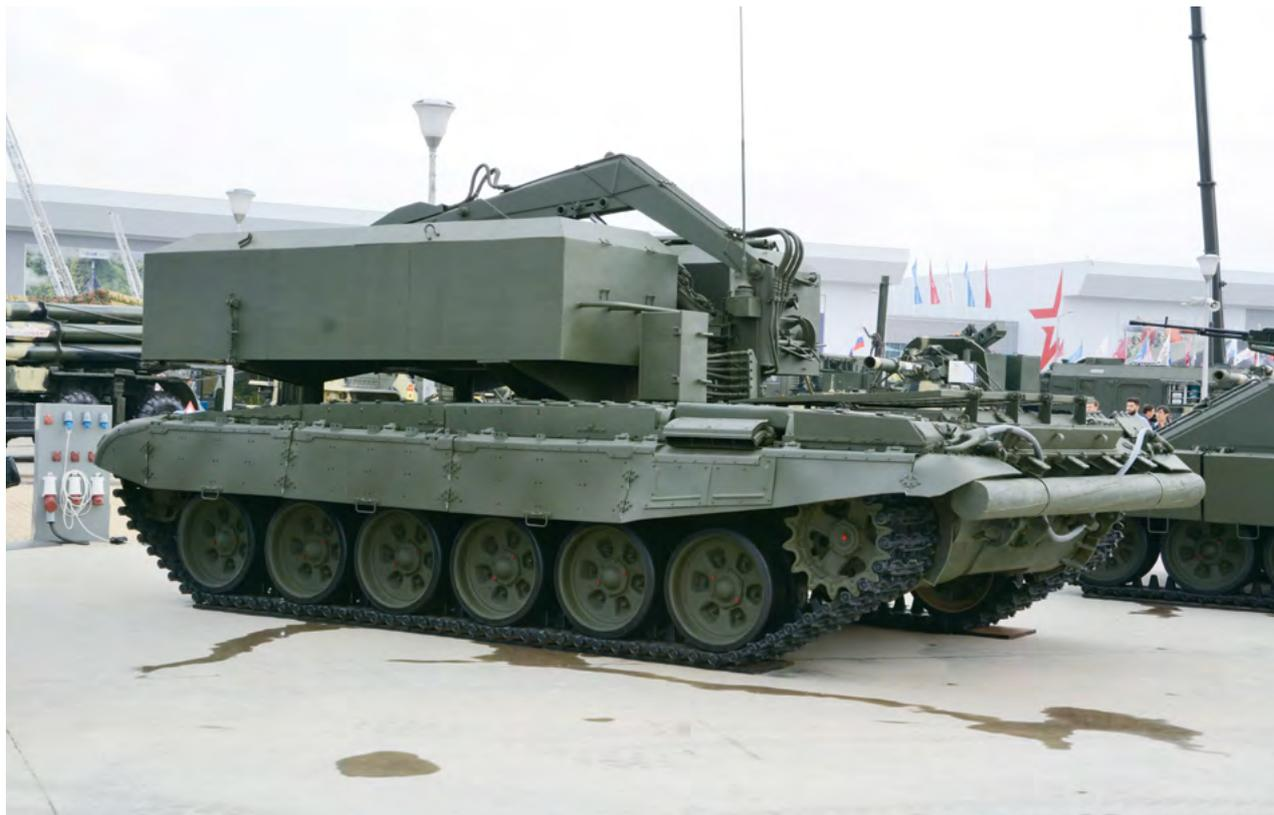
Транспортно-заряжающая машина ТЗМ-Т несет на себе два бронированных контейнера с дополнительным боекомплектом и гидравлический кран для перезагрузки.
